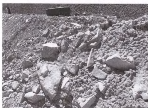
照片 10-8 堆场土石混合料
