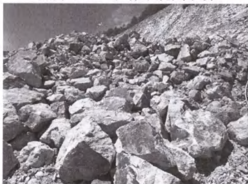
照片 10-7 堆场土石混合料
